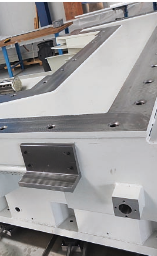
Kruissledes en andere kritische delen worden nog met de hand geschraapt voor een betere vlakheid.
