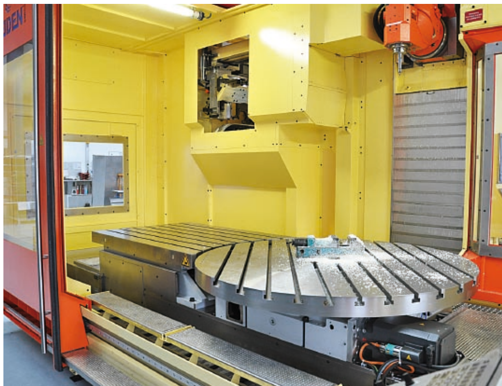
Deze BFR2 voor Alstom heeft de rondtafel rechts, bovendien is de machine aan de achterkant verbreed zodat er een grotere draaicirkel ontstaat.
