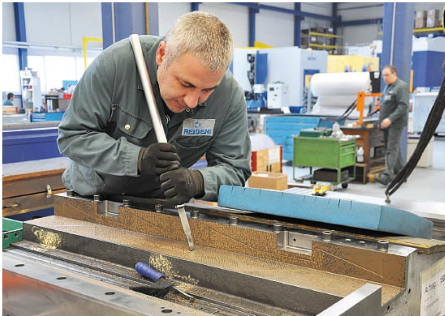
Kruissledes en andere kritische delen worden nog met de hand geschraapt voor een betere vlakheid.
