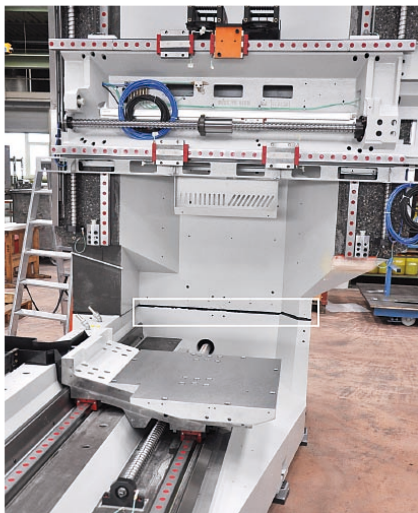
Het bed van de RX10, let op hoe het bed aan de kant waar de toegangsdeur komt schuin loopt. De spantransporteur staat onder een hoek. Daardoor stapt de operator later als het ware in de machine en kan hij veel beter bij het werkstuk komen. In witte kader: bed en kolom zijn met een speciale lijm met elkaar verlijmd. (Foto's: FCP)
